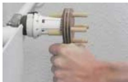
↑ Drehhilfe (Hebelwirkung ausnutzen)
