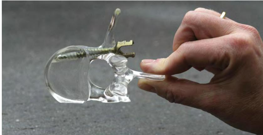
Das Modell veranschaulicht, wie knapp der Platz ist, wenn eine Titanschraube in den Wirbelkörper platziert wird.
